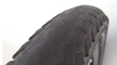
Les sculptures ne sont plus présentes mais il reste encore du caoutchouc. Ce pneu peut éventuellement encore être utilisé.
