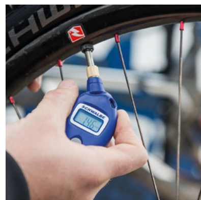
Contrôle de pression avec l'Airmax Pro.
