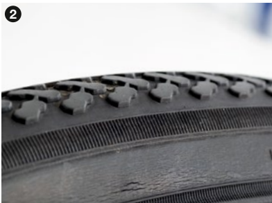
Fissures de vieillissement
