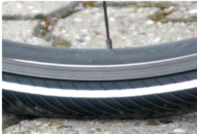
Pression correcte. Le pneu est à peine déformé sous le poids du cycliste.
